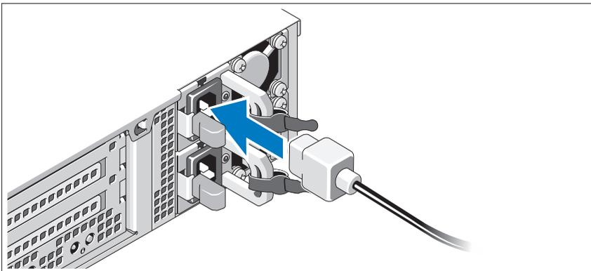
Conecte los cables de alimentación al sistema y, si se utiliza un monitor, conecte el cable de alimentación correspondiente al monitor.
