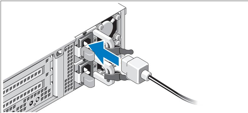
Connectez le ou les câbles d'alimentation au système et, si vous utilisez un moniteur, connectez son câble d'alimentation à celui-ci.
