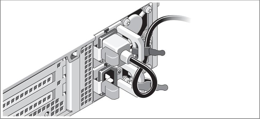
Dobre o cabo de alimentação do sistema em forma de laço conforme mostra a ilustração e prenda-o com a tira fornecida. Conecte a outra extremidade do cabo de alimentação a uma tomada elétrica aterrada ou a uma fonte de alimentação separada, por exemplo, uma UPS (Uninterruptible Power Supply [Fonte de Alimentação Ininterrupta]) ou a uma PDU (Power Distribution Unit [Unidade de Distribuição de Energia]).
